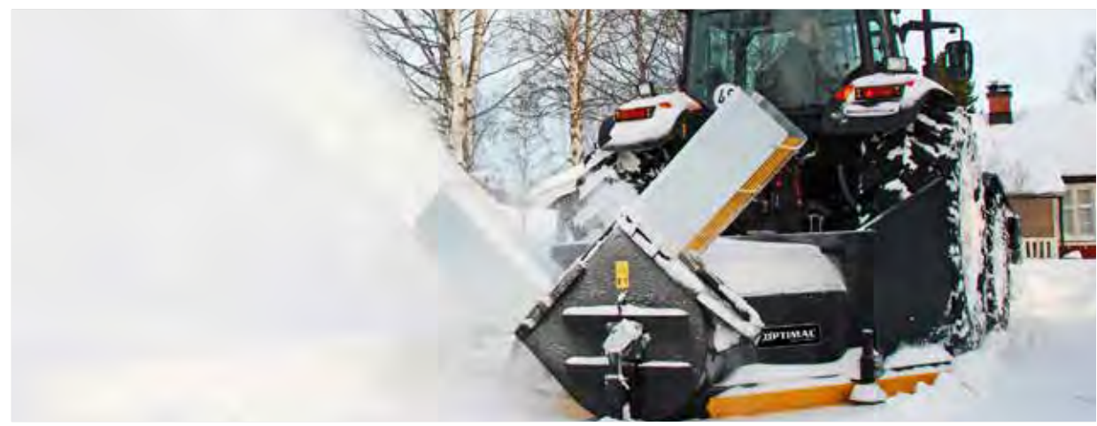
Trejon Optimal 225-2 mit einer Arbeitsbreite von 225 cm und doppeltem Auswurf
