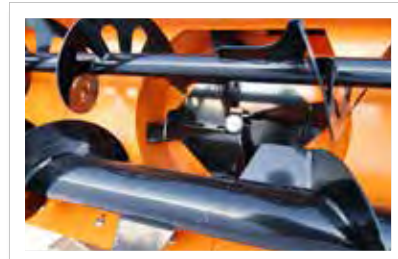
Turbinegehäuse aus Hardox-450 Hochleistungsstahl gefertigt.
