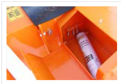
Ein Werkzeugkasten mit Halter für Scherbolzen ist Standard bei allen HD- und hydraulischen Modellen. Er bietet Platz für Scherbolzen, Werkzeug, Schmierausrüstung usw.
