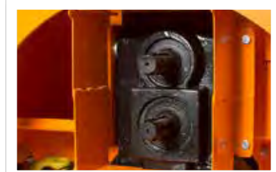
HD-Getriebe HD, 540 rpm Heckmontage/ 1 000 rpm Frontmontage.
