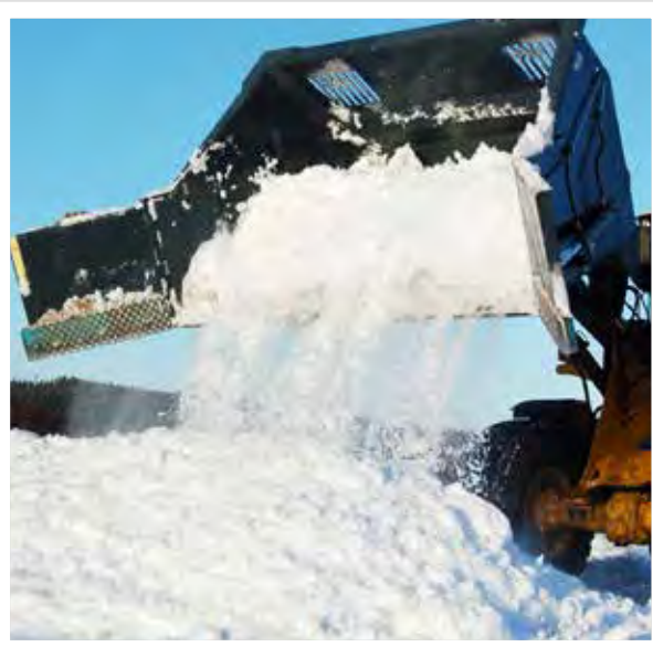
Die Räumschaufel hat eine immense Aufnahmekapazität, und dank der konischen Form mit abgerundeter Rückseite fällt der Schnee beim Entleeren/Kippen leichter heraus.
