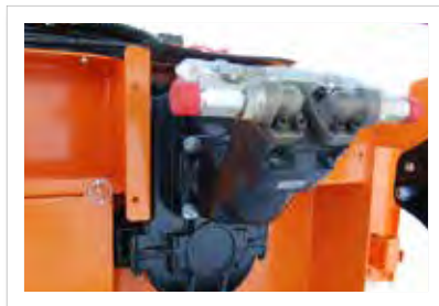
Der Hydraulikmotor (Kolbentyp) ist direkt am Getriebe montiert und auf hohen Druck und Dauerbetrieb ausgelegt. Gilt für 1802H–2452H.
