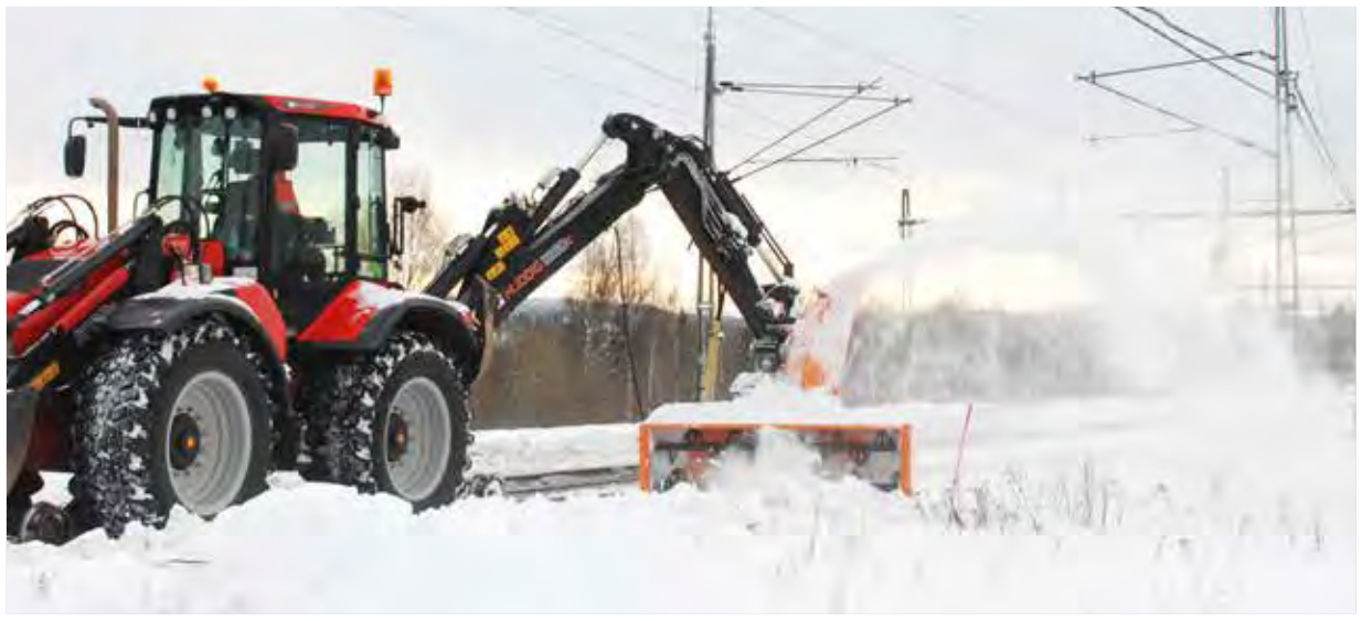
Hydraulische Schneefräse 2202H von Trejon Optimal, hier montiert an einem Huddig 1260, für die Schneeräumung an Bahnhöfen, Haltestellen und entlang der Gleise.
