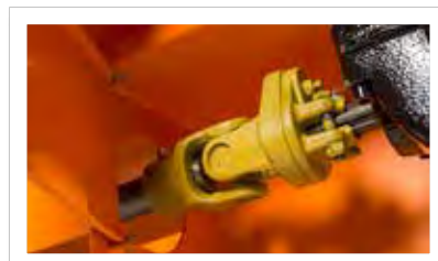
Hohe Sicherheit: Zuführschnecke und Rotor sind durch eine Scherbolzenkupplung geschützt.
