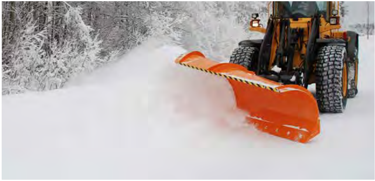
Stark positiver Anstellwinkel für sauberes Räumen bei hohen Geschwindigkeiten.
