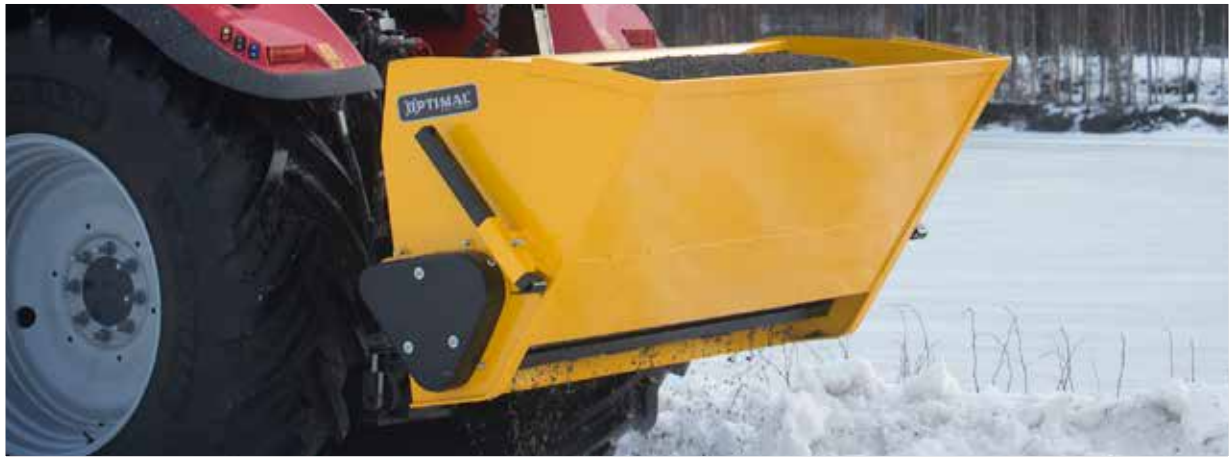
Trejon Optimal Walzenstreuer sind an alle Arten von Schnellwechslern angepasst. Das Bild zeigt den SP1000 an einem Traktor.
