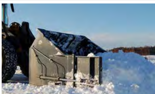
Die Räumschaufel hat eine immense Aufnahmekapazität, und dank der konischen Form mit abgerundeter Rückseite fällt der Schnee beim Entleeren/Kippen leichter heraus.
