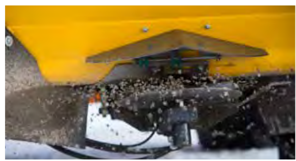
Streuteller und zugehörige Teile aus rostfreiem Stahl. Die Tellergeschwindigkeit ist stufenlos einstellbar.
