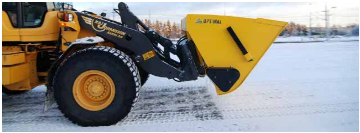
Trejon Optimal Walzenstreuer sind an alle Arten von Schnellwechslern angepasst. Das Bild zeigt den SP2700 an einem Radlader.
